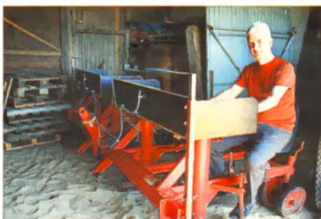
Eigenentwicklung des Miscanthus-Pioniers: Ein Schmied baute diese Pflanzmaschine aus einem Maishäcksler.
